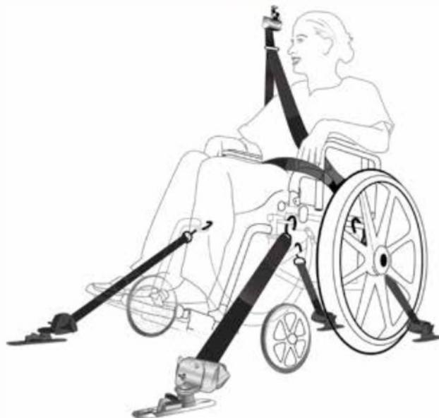
**Figura 37 – Exemplo do sistema de travamento fixado no piso**
