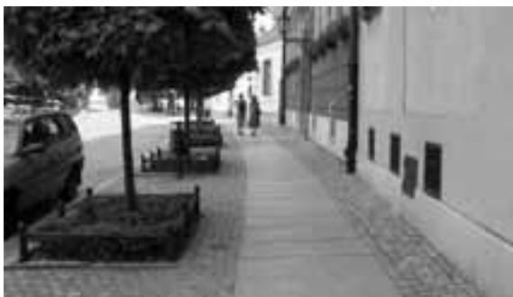
Acera con franja de elementos y franja de circulación claramente definidas. El cambio de material usado en la vereda favorece el desplazamiento.
