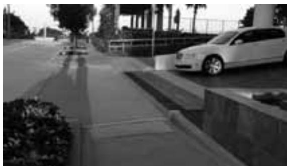
Una franja de advertencia en la vereda indica la proximidad de una salida de vehículos.
