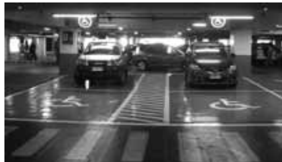
Estacionamientos subterráneos de ancho correcto y franja de circulación que lleva hasta los ascensores para proteger a las personas del flujo vehicular.
