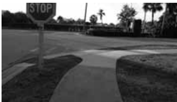
Cruce en vereda angosta. La vereda baja en todo su ancho hasta alcanzar la cota de la calzada. Una franja de textura diferente hace perceptible el cruce.
