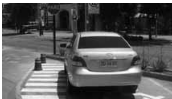
Estacionamiento diagonal en la vía pública con franja de ascenso - descenso que debe continuar hasta el acceso a la vereda.
